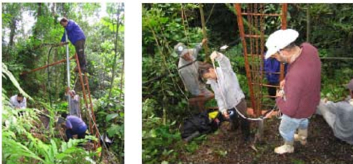
Figura 2.45 e 2.46 – Amostragem com a utilização de amostrador tipo vibrocorer
